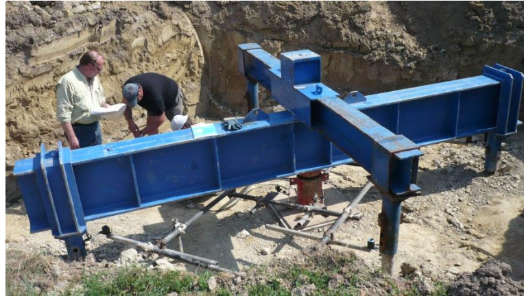
PRUEBA DE CARGA EN SITIO 4mm@120 tons
